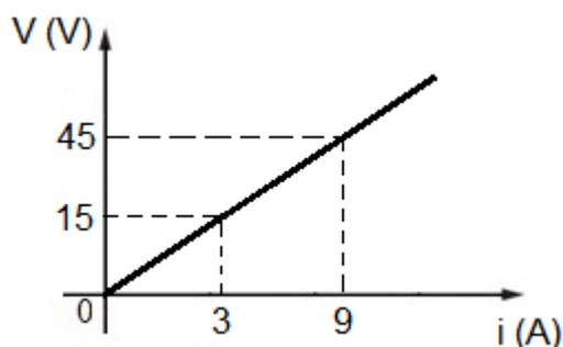
O valor da resistência elétrica desse resistor e a diferença de potencial aplicada ao resistor, quando percorrido por uma corrente de 5 A, são, respectivamente:
